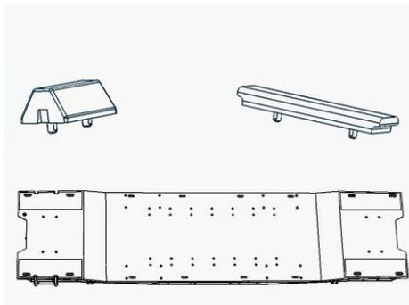
Mit dem Lochraster haben Sie die Möglichkeit das von Ihnen gewählte Modell optimal zu sichern. Stecken Sie nur die Bremskeile in die passenden Löcher.
