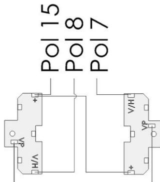
Für eine einfachere Montage empfiehlt es sich, die Litzen zuerst an den Printplatten anzuschließen. Beim Löten ist darauf zu achten, dass die Leiterbahnen auf Lichtprint sowie Schnittstelle nicht miteinander verbunden werden. Es sollte mit Zinn gespart werden da bei zu grossen Zinnansammlungen ein Kurzschluss mit dem Chassisboden entstehen könnte.
