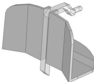
Im Gehäuse sind nun noch die alten, einteiligen Lichtleiter zu entfernen und mit den neuen zu ersetzen. Hierbei wird der obere, abgewinkelte Lichtleiter in den Führerstand gesteckt und am Gehäuse fixiert.
