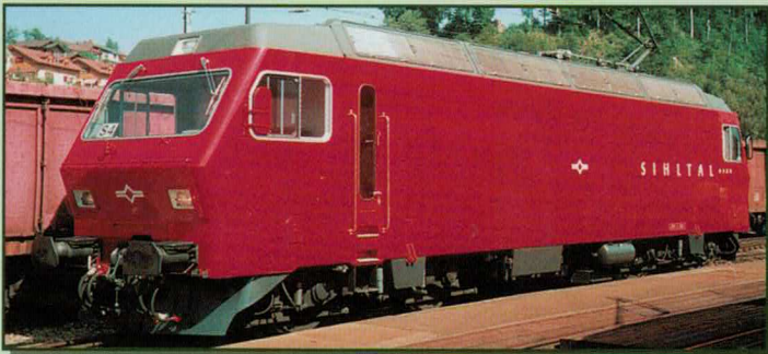
Nr. 264~/265= Re 4/4 Umrichterlok der Sihltalbahn. Re 4/4 Loc à convertisseurs du Sihltalbahn.
