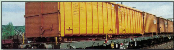
Nr. 380~/381= SBB Spezial-Flachwagen Typ Rs-x für Abrollcontainer. CFF wagon plat à bogies de type Rs-x, pour le transport de conteneurs mobiles ACTS.
