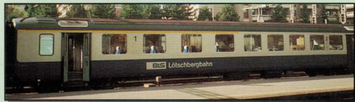
Nr. 452~/453= EW 1 2. Klasse der BLS. Voiture unifiée type I, 2 e classe en version BLS.
