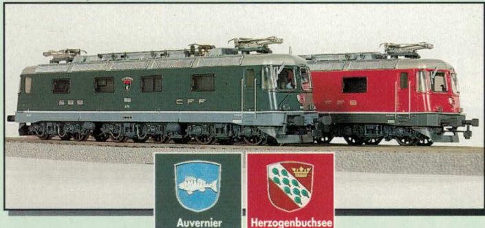
Nr. 196~/197= Re 6/6 grün/verte "Auvernier" (11658) Nr. 203~/204= Re 6/6 rot/rouge "Herzogenbuchsee" (11630) Diese Neuauflage der Re 6/6 erlaubt uns wiederum zwei neue Wappen zu berücksichtigen. Beide Loks sind mit rechteckigen Halogenscheinwerfern bestückt. Die grüne Nummer 11658 erhielt zusätzlich noch die Treppe für UIC-Kabel und den Handlauf.
