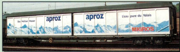
Nr. 384~/385= Geschlossener 4-achsiger Güterwagen Typ Habils. Wagon couvert à bogies, type Habils.
