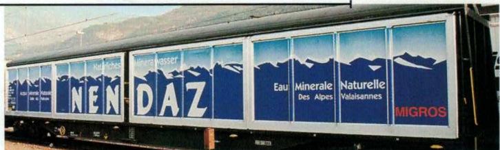
Nr. 384~, Nr. 385= Nendaz Geschlossener, 4-achsiger Güterwagen Typ Habils, SBB CFF FFS Wagon marchandise couvert 4 essieux, type habils, SBB CFF FFS
