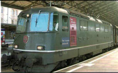
16 210 : SBB Re 4/4 II grün, Klima, Lok Nr. 11160 mit roter Klima-Abdeckung und die Aufschrift «Für unser Personal». Dies war die erste Klimaanlage der Re 4/4 Serie.
