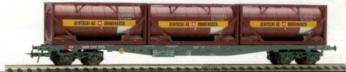
77 006 ~ AC, 77 007 = DC SBB Flachwagen für Container Typ Sgs, mit 3x20 ft. Tankcontainer von Bertschi
