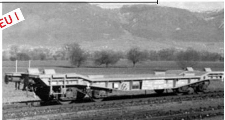
Art. Nr. 608~/609= Tiefladewagen Typ Slmmps für Lasten bis 54 t. Wagon surbaissé type Slmmps, avec une limite de charge de 54 t.
