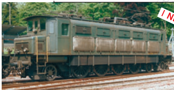
Art. Nr. 134~/135= Sécheron 5 Ae 4/7 Nr. 10951, Ausführung von Sécheron mit 5 Lüftergitter. Ae 4/7 No. 10951, série de Sécheron, munie de 5 jalousies.
