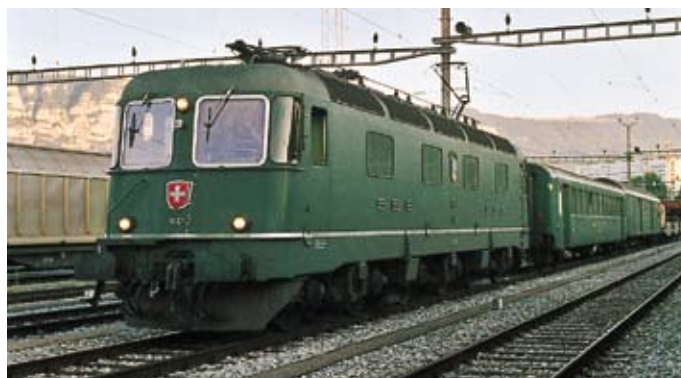
Re 6/6 11661 «Gampel-Steg» im Zwischenzustand: UIC-Steckdose, Handlauf und Treppe, aber noch runde Stirnlampen, Genève-La Praille, 22.8.2000.
