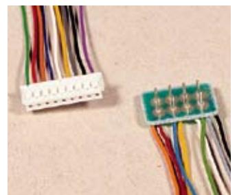
9-polige Schnittstelle nach NEM 653 (oben) und 8-polige Schnittstelle nach NEM 652
