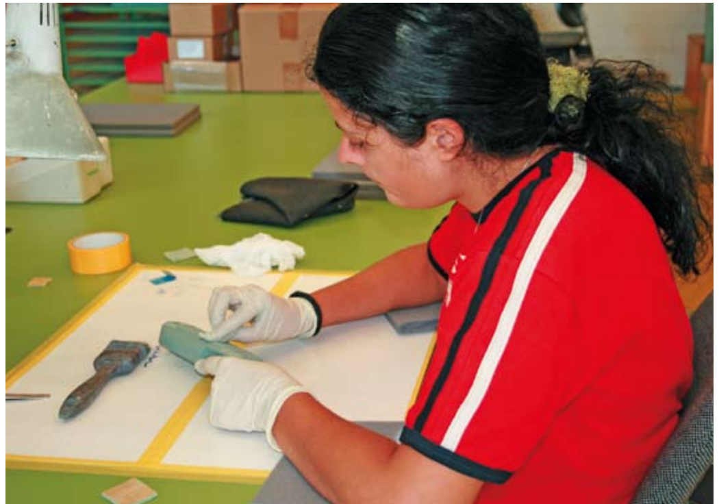
...hier beim Abdecken eines Lokgehäuses vor dem nächsten Lackiervorgang.
