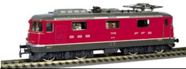
16 031 : SBB Re 4/4 rot, Klima, Lok Nr. 11148 Alte Generation, 1 Scherenpanto
