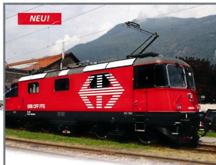
16 228 : SBB Re 420 rot, Lok Nr. 420 202-4 «Lion» Modernisierte und neu gestaltete Re 4/4 II die für zusätzliche S-Bahn-Kompositionen eingesetzt werden. LED-Beleuchtung und Klimaanlage
