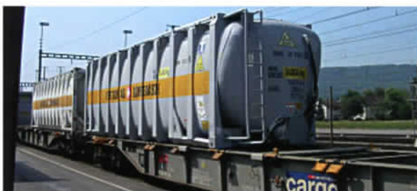
Nr. 356 ~/ 357 = Bertschi Neu: SBB Flachwagen, Typ Sgs mit 2 30 ft. Bulkcontainer von Bertschi.
