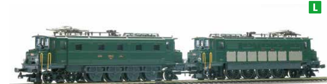
36 008 : Ae 4/7 Doppeltraktion Ae 4/7 Sècheron mit 5 Lüfter, Lok Nr. 10945 Ae 4/7 Sècheron mit 7 Lüfter, Lok Nr. 11010
