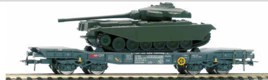
78 004 ~ AC, 78 005 = DC SBB Tiefladewagen Typ Slmmnps, mit Centurion Panzer.
