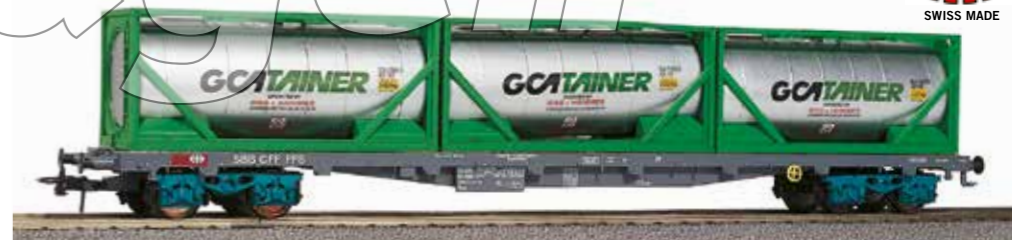
77 000 ~ AC, 77 001 = DC SBB Flachwagen für Container Typ Sgs, mit 3x20 ft. Tankcontainer von GCA.
