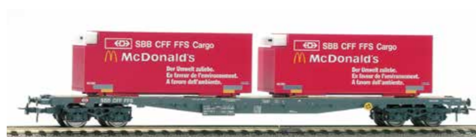
73 018 ~ AC, 73 019 = DC SBB Flachwagen für Container Typ Sgs, mit 2xWB Kühl-Container von McDonald's.
