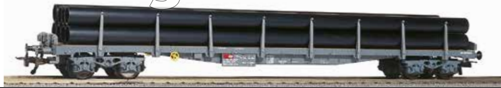
70 038 ~ AC, 70 039 = DC SBB Flachwagen mit Klapprungen Typ Rs, mit Röhren-Ladung schwarz.
