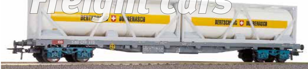
77 060 ~ AC, 77 061 = DC SBB Flachwagen für Container Typ Sgs, mit 2x30 ft. Tankcontainer von Bertschi.
