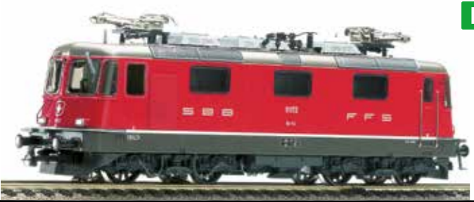
16 030 : SBB Re 4/4 m rot, Ex MthB, Lok Nr. 11172 Mit Klimaanlage, aufgeklebtes CH-Kreuz. Inbetriebnahme: 1969 Gewicht: 80 t Leistung: 6320 PS V Max.: 140 km/h
