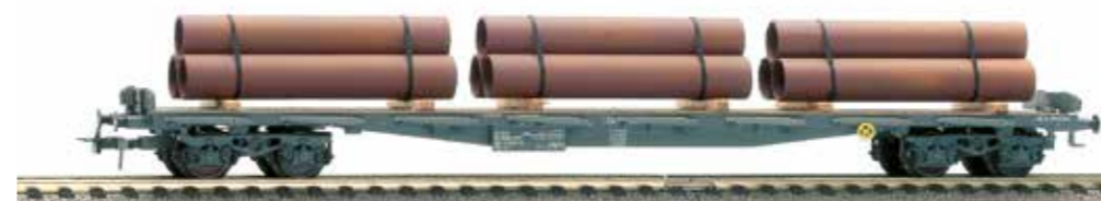
70 030 ~ AC, 70 031 = DC SBB Flachwagen mit Klapprungen Typ Rs, mit Gasröhren-Ladung 3-teilig.
