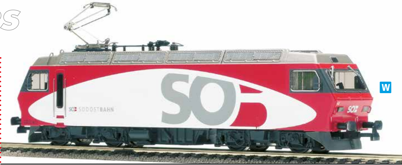
26 019 : Re 456 SOB, Lok Nr. 456142-7 Neues SOB Design. Inbetriebnahme: 1987 Gewicht: 68 t Leistung: 4300 PS V Max.: 130 km/h
