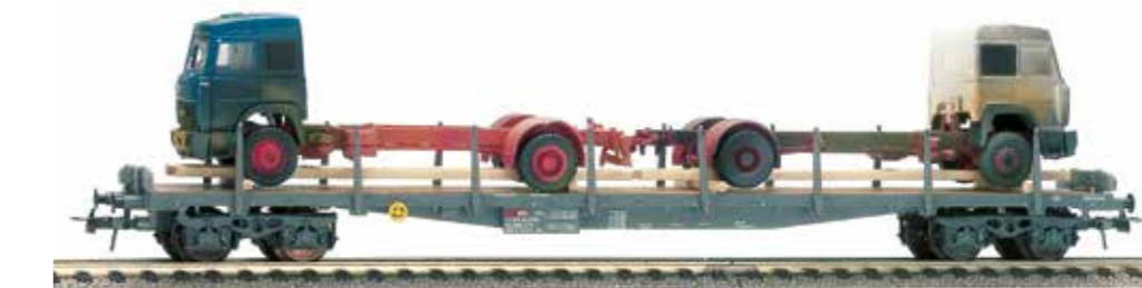
70 016 ~ AC, 70 017 = DC SBB Flachwagen mit Klapprungen Typ Rs, mit Abbruchlastwagen (LKW).
