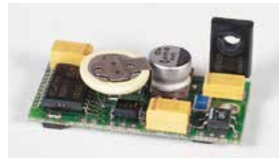
504-2 Neuer elektronischer Fahrtrichtungsumschalter mit Konstantlichthaltung (6 Volt) und Schlusslichtfunktion für Permanentmagnet-Motoren im Wechselstrombetrieb.
