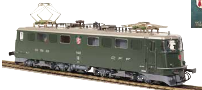
11 022 : Ae 6/6 Kantonlokomotive (Ex Städtelok) grün, Jura, Lok Nr. 11483 Inbetriebnahme: 1958-66 Gewicht: 120 t Leistung: 5830 PS V Max.: 125 km/h
