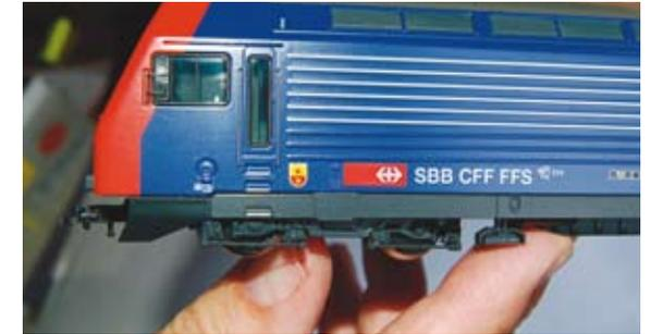
Mit dem Tampon-Druck-Verfahren drucken wir gestochen scharf. Am besten feststellbar mit der Lupe. Selbst Beschriftungen kleiner als 0,3 mm sind noch einwandfrei lesbar. Diese Fülle von faszinierenden Details kriegen wir hin mit viel Liebe und Geduld.
