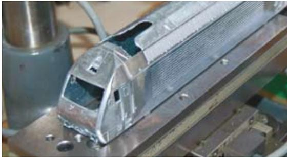
Der so entstandene Gussrohling wird anschliessend in aufwendiger Handarbeit entgratet und bearbeitet. An einem Lokgehäuse zum Beispiel werden bis zu 25 Bearbeitungsoperationen vorgenommen, bevor dieses lackiert werden kann.
