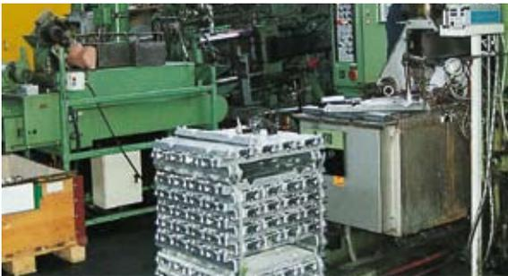
Alle wichtigen Bestandteile von HAG-Lokomotiven und -Wagen sind aus Zink-Druckguss hergestellt. Die Zink-Aluminium-Legierung wird mit einer Temperatur von ca. 420°C geschmolzen und dann mit einem Druck von zirka 200kg/cm<sup>2</sup> in die Form eingespritzt, wo das Metall dann erstarrt.
