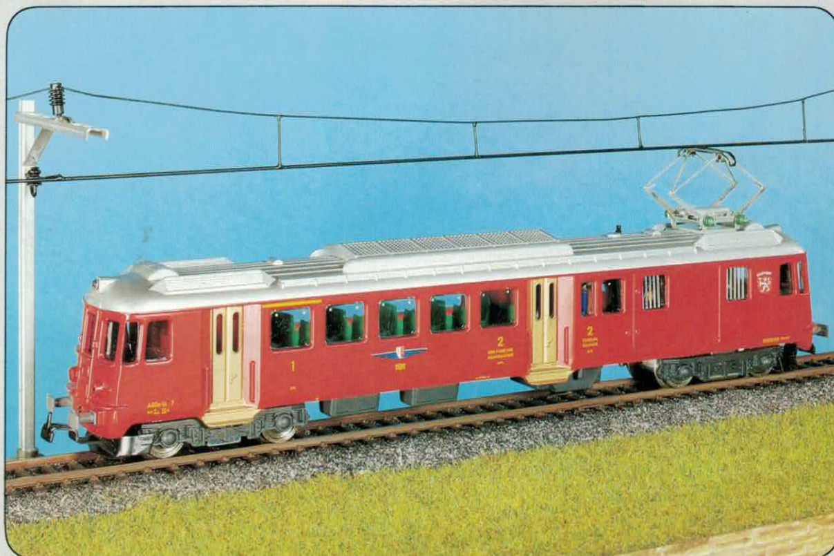
MO-Triebwagen ABDe Nr. 260 Wechselstrom, Nr. 261 Gleichstrom. Die Normalspur-Privatbahn Martigny-Orsières (MO) verfügt über 3 Stück dreiteilige Pendelzüge, die je aus einem Triebwagen, einem 2.-Klass-Personenwagen und einem Steuerwagen bestehen. Jeder Triebwagen ist mit einem der 3 an der Bahnlinie liegenden Gemeindewappen, Martigny-Bagnes-Orsières, geschmückt. Die 3 Gemeindewappen und die entsprechenden Fahrzeugnummern liegen der Packung bei und können nach Wahl aufgeklebt werden. 1500 PS, 63 t, 100 km/h.
