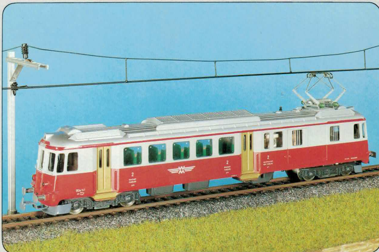
WM-Triebwagen Nr. 250 Wechselstrom, Nr. 251 Gleichstrom. Nur 8,233 km lang ist die Strecke der Normalspur-Privatbahn, die Wohlen mit Meisterschwanden verbindet. Normalerweise pendelt hier ein Triebwagen Typ BDe 4/4 solo. In Stosszeiten wird noch ein Steuerwagen gekoppelt. Inbetriebnahme 1966, 1500 PS, 63 t, 100 km/h.
