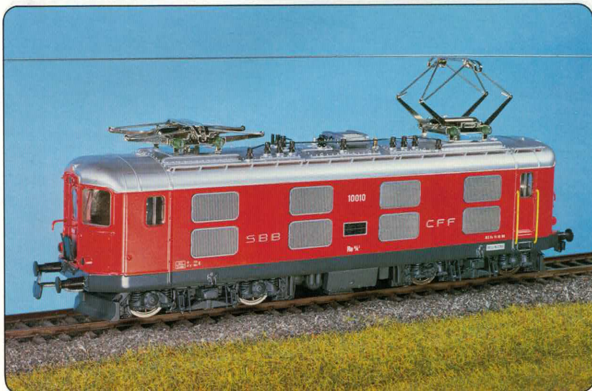
Re 4/4 I Serie 1 Nr. 237 Wechselstrom, Nr. 238 Gleichstrom. Die Lok Nr. 10010 ist die erste Maschine dieses Typs, die 1984 die neue rote Lackierung erhielt.
