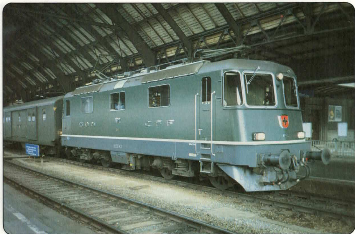
Re 4/4 II Nr. 167 Wechselstrom, Nr. 168 Gleichstrom. Die ersten 7 der 1984 an die SBB ausgelieferten neuen Re 4/4 II wurden noch grün lackiert und werden bis zu ihrer ersten Generalrevision auch so bleiben. Inbetriebnahme 1984, 6320 PS, 80t, 140km/h.
