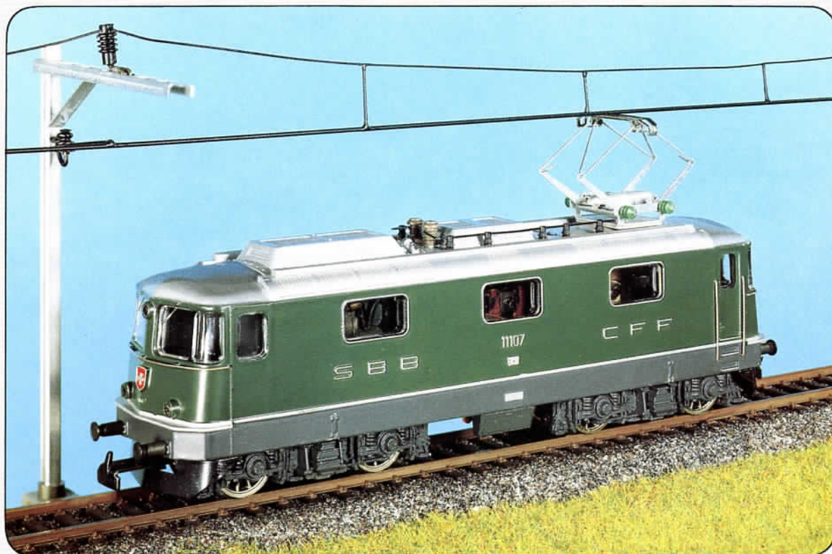
Re 4/4" Nr. 160 Wechselstrom, Nr. 161 Gleichstrom. Kraft und Schnelligkeit zeichnet diese Lok aus, welche heute am häufigsten auf dem Schweizer Eisenbahnnetz verkehrt. Sie wird deshalb sowohl bei Personen- und Schnellzügen wie auch bei schweren Gütertransporten eingesetzt. Inbetriebnahme 1967/68, 6320 PS, 80 t, 140 km/h.
