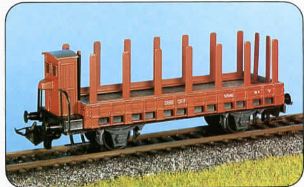
Niederbordwagen mit Bremserhaus Nr. 340 (Rungen abnehmbar) Wagon-plate-forme avec poste de garde-frein n° 340 (ranchers amovibles)
