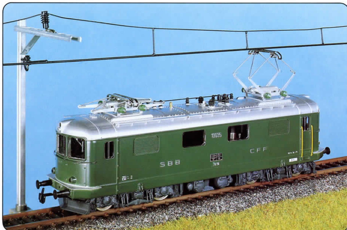
Re 4/4 I Serie 2 Nr. 220 Wechselstrom, Nr. 221 Gleichstrom. Zusammen mit ihrer Vorgängerin und Schwestermodell (Nr. 225/226) galt diese erste Bo-Bo-Lokomotive als revolutionär im schweizerischen Lokomotivenbau. War sie doch die erste zierliche und elegant aussehende Schnellzuglok. Inbetriebnahme 1950/51, 2520 PS, 58t, 125 km/h.
