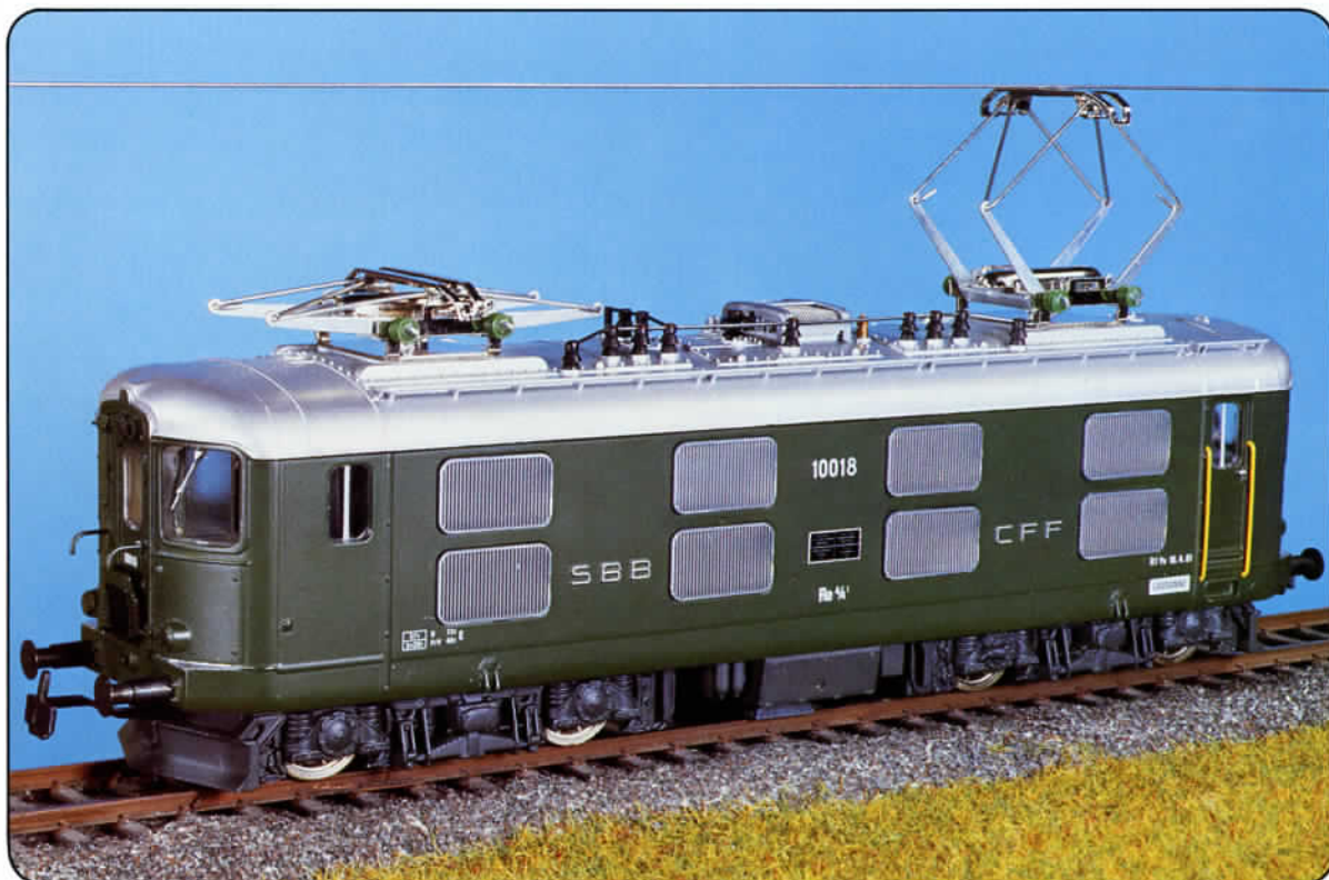
Re 4/4! Serie 1 Nr. 225 Wechselstrom, Nr. 226 Gleichstrom. Diese mit der Vielfachsteuerung ausgerüstete Lokomotive wurde speziell für den Pendelzugverkehr konzipiert. Sie konnte aber auch für Schnellzüge im Flachland eingesetzt werden. Noch heute leistet sie treue Dienste auf Nebenstrecken. Inbetriebnahme 1946–1948, 2480 PS, 57 t, 125 km/h.
