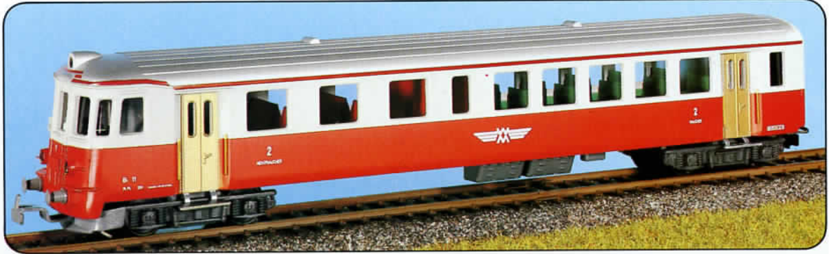
WM-Steuerwagen Nr. 470 WS, Nr. 471 GL. Steuerwagen umschaltbar auf Dreispitz-Signal oder Schlusslicht, mit Innenbeleuchtung.
