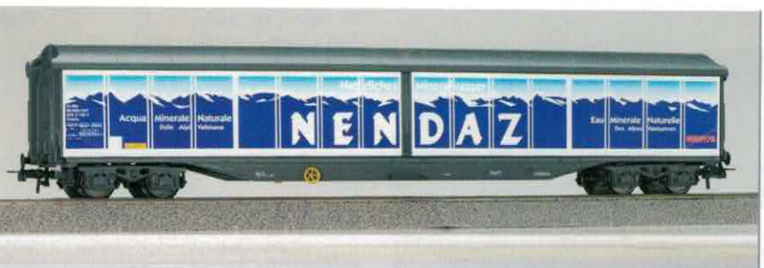
Nr. 384~, Nr. 385= SBB, Typ Habils, geschlossener, 4-achsiger Güterwagen mit gerippten Seitenwänden.
