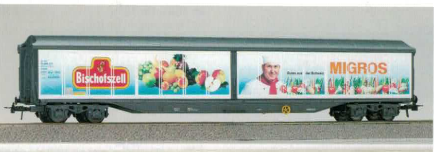
Nr. 384~, Nr. 385= SBB, Typ Habils, geschlossener, 4-achsiger Güterwagen mit gerippten Seitenwänden.
