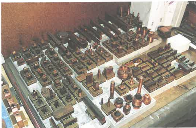
Details wie Rippen, Türgriffe oder Nietenköpfe werden in die Einsätze und Schieber des Werkzeugs erodiert. Für jeden Erodiervorgang muss der Werkzeugbauer je eine Schrupp- und eine Schlicht-Elektrode herstellen. Zu sehen ist hier der Schlicht-Elektroden-Satz für das relativ einfache Gehäuse der Re 460 – bei der Ae 4/7 wird's komplizierter.
