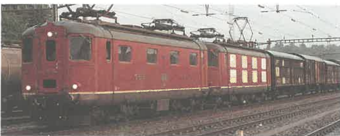
Les dernières années d'exploitation ont vu la redécouverte de la conduite multiple des Re 4/4 I 10001 à 26: N° 10017 et 10019 arrivant en gare de Genève-La Praille le 5.10.95.
