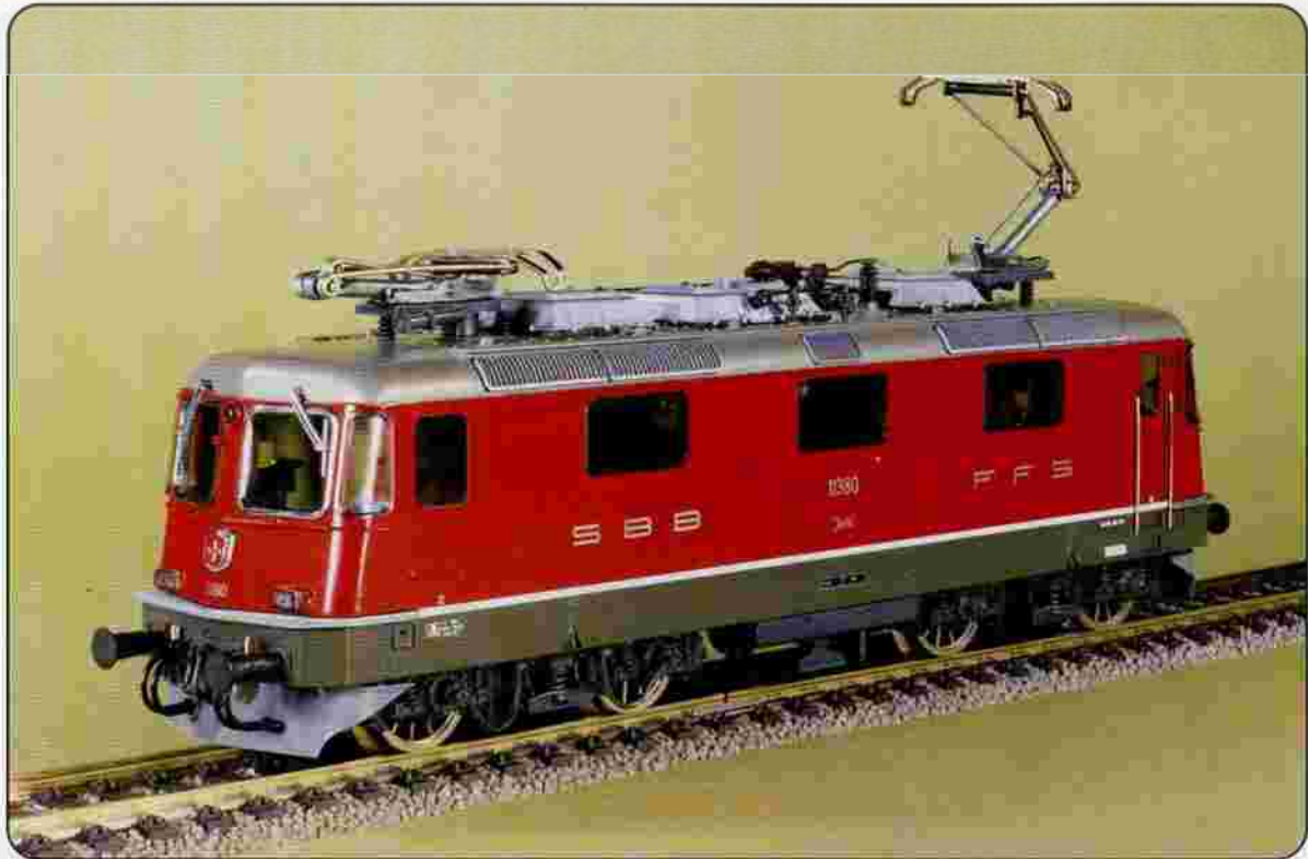
Re 4/4II neue Ausführung Nr. 165 Wechselstrom, Nr. 166 Gleichstrom. Die neueste Ausführung der Re 4/4II mit 2 Stromabnehmern, rechteckigen Halogenscheinwerfern und der neuen roten Lackierung. Auch das HAG-Modell ist eine komplett neue Konstruktion. Inbetriebnahme 1984, 6320PS, 80t, 140km/h.
