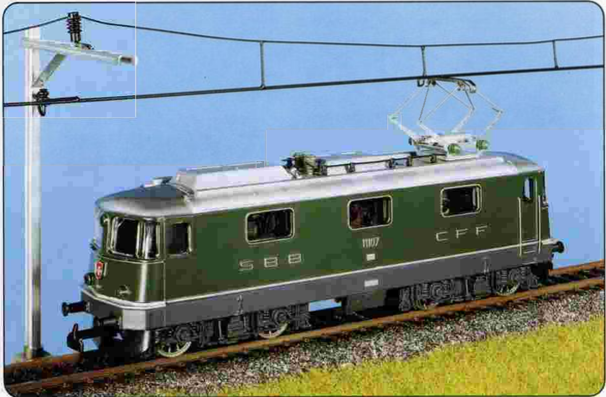
Re 4/4 II n° 160 c.a., n° 161 c.c. C'est en 1967 que les CFF mirent les premières locomotives de ce type en service. Dotées d'un pantographe traditionnel et d'un carénage encore plus court, ces Re 4/4 II sont toujours en exploitation. 6320CV, 80t, 140km/h.
