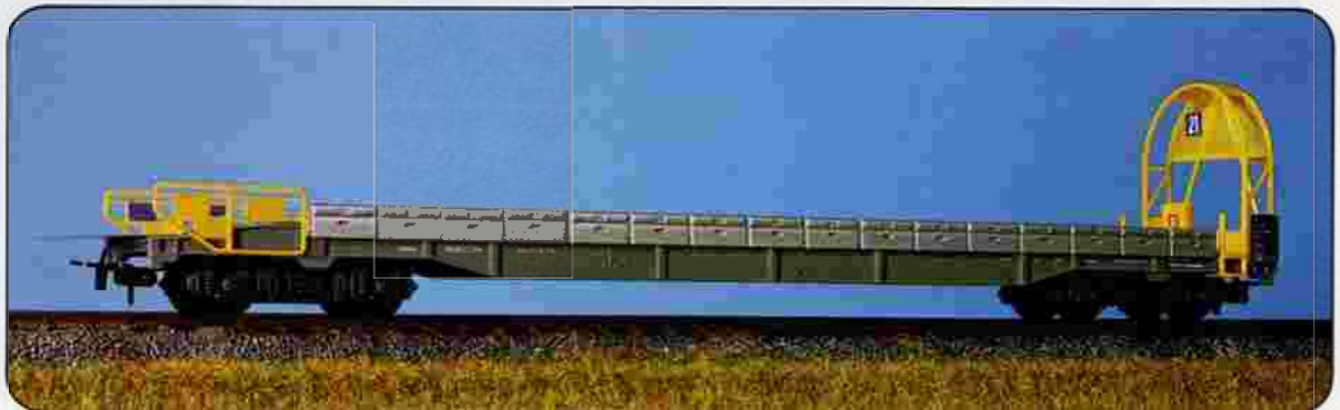
BLS-Auffahrwagen Nr. 375 WS, Nr. 376 GL. Der erste und der letzte Wagen eines jeden Autotransportzuges ist ein Auffahrwagen, über welche die Autokolonne den Zug befährt und wieder verlässt.
