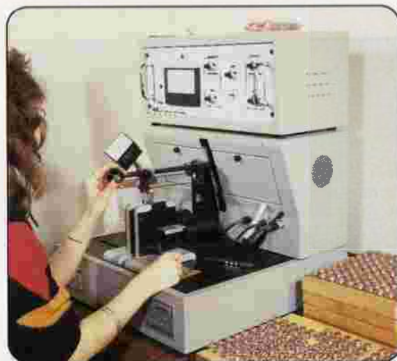
Auf modernste Art werden Rotoren ausgewuchtet Les rotors sont équilibrés selon les méthodes les plus modernes
