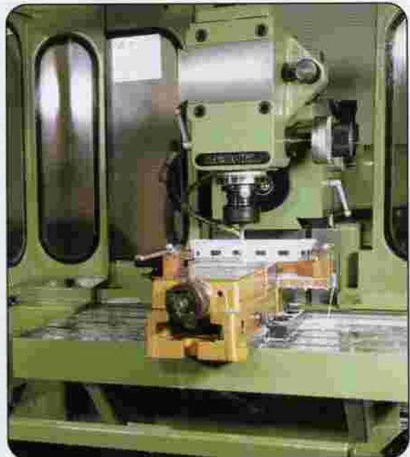
Lokgehäuse werden auf der CNC Fräsmaschine bearbeitet Les carrosseries des locomotives sont travaillées sur une fraiseuse CNC
