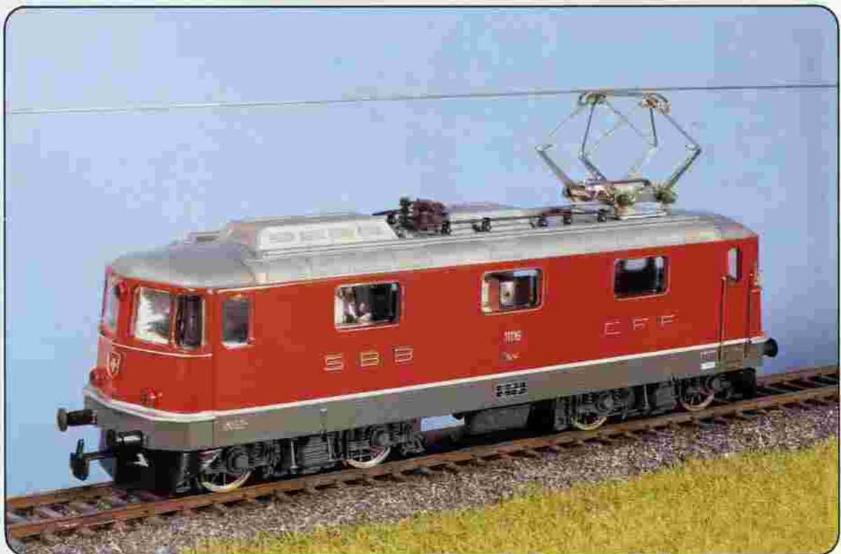
Re 4/4 II Nr. 162 Wechselstrom, Nr. 163 Gleichstrom. Seit Mitte 1984 werden auch ältere SBB-Lokomotiven wie z. B. diese Re 4/4 II der ersten Serie bei ihrer nächsten Generalüberholung auf Rot umlackiert. Hier die bereits renovierte Lok Nr. 11116. Inbetriebnahme 1967/68, 6320PS, 80t, 140km/h.
