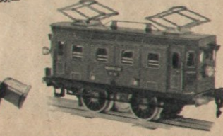
«Märklin» elektrische Lokomotive, RS 66/12900, 2achsfig, vor- und rückwärtsfahrend, mit automatischer Umschaltung für Fernsteuerung, elektrische Stirlampe, grün, 19 cm lang Fr. 50.—
