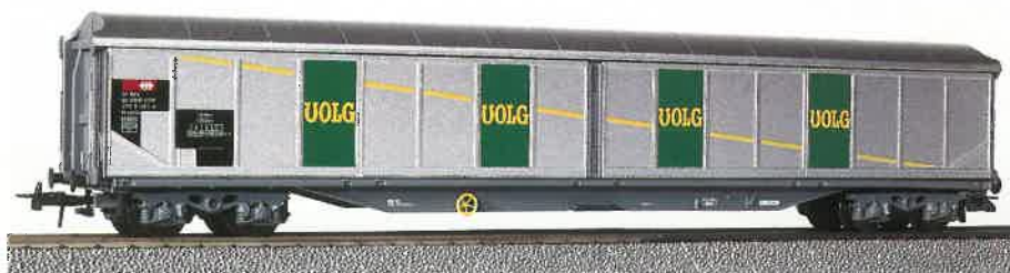
Nr. 384~, Nr. 385 = VC SBB, Typ Habils, geschlossener, 4-achsiger Güterwagen mit gerippten Seitenwänden.
