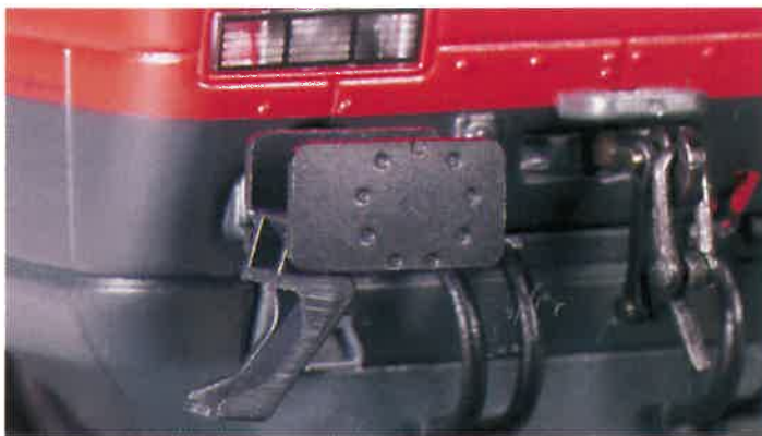
Die Puffertreppe der Re 460 lässt sich, wie beim Original, umklappen. Les escaliers de service des 460 sont amovibles, comme sur l'original.
