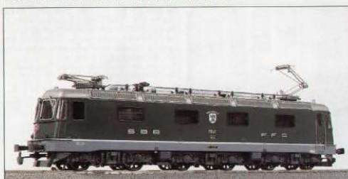
Re 6/6 Nr. 205-, Nr. 206= The 85 locomotives with nonarticulated bodies delivered to the SBB for the St.Gothard line from 1975 to carry the name and coats of arms of places in Switzerland which are of special importance for transport or have a special link with the railway. This model is supplied with a different number and name-plate on each side. Entered service 1975-1979. 10600hp, 120tons, 140km/hr. Le 85 locomotive per la linea del Gottardo, consegnate alle FFS nel 1975, hanno una cassa indivisa. Sono decorate con i nomi e gli stemmi di località svizzere che hanno un significato speciale per il trasporto ferroviario o un rapporto particolare con la ferrovia in generale. Ogni lato di questo modello viene fornito con un numero di serie ed uno stemma diverso. Entrate in servizio 1975-1979. 10600CV, massa 120t, vel.max.140km/h.
