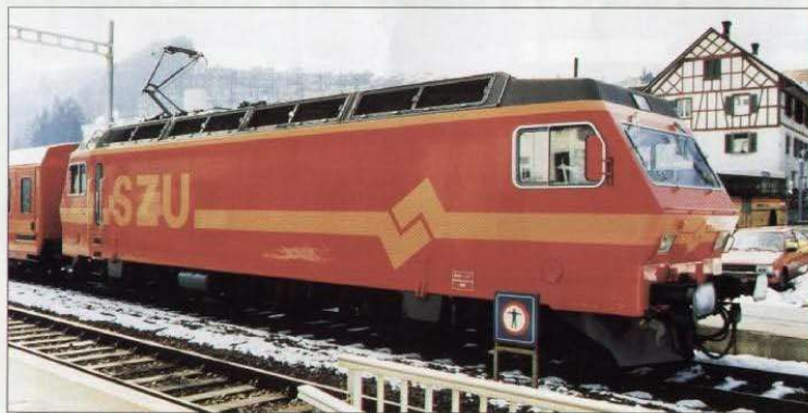
Re 4/4 Frequency converter loco of the SZU / Locomotore a convertitore delle ferrovie SZU Nr. 188-, Nr. 189-
